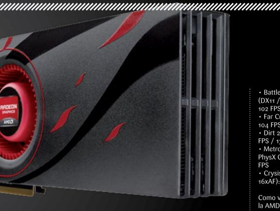
pruebas. Con el mismo, la placa en reposo alcanzó los 40 grados en modo por defecto y los 41 grados en modo overclock, mientras que bajo carga máxima la placa llegó a los 85 grados en modo por defecto y a los 87 grados en modo overclock. Si bien podría ser más saludable que funcione a menor temperatura, en términos generales es un buen rendimiento, ya que estamos hablando de dos placas de video en una sola, y eso tiene su repercusión en el consumo y calor generado.
