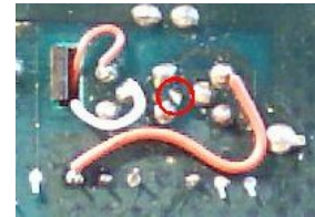
Figura 13, Corte de pistas RGB
