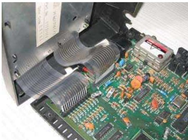
Imagen 3. Conexiones de la membrana a la placa base
