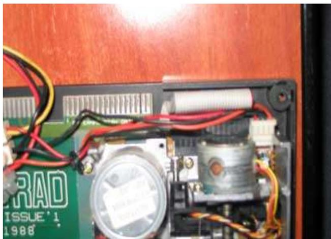
Imagen 5. Conectores de datos y alimentación eléctrica
