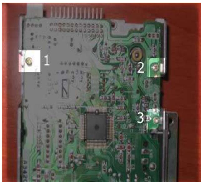
Imagen 7. Placa de la disquetera. Tornillos 1, 2 y 3
