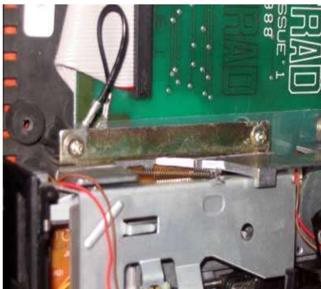
Imagen 4. Tornillos de sujeción de la disquetera
