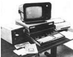
Figura TET-01. El Electrónica 60 es un ordenador ruso, clon del PDP-11
