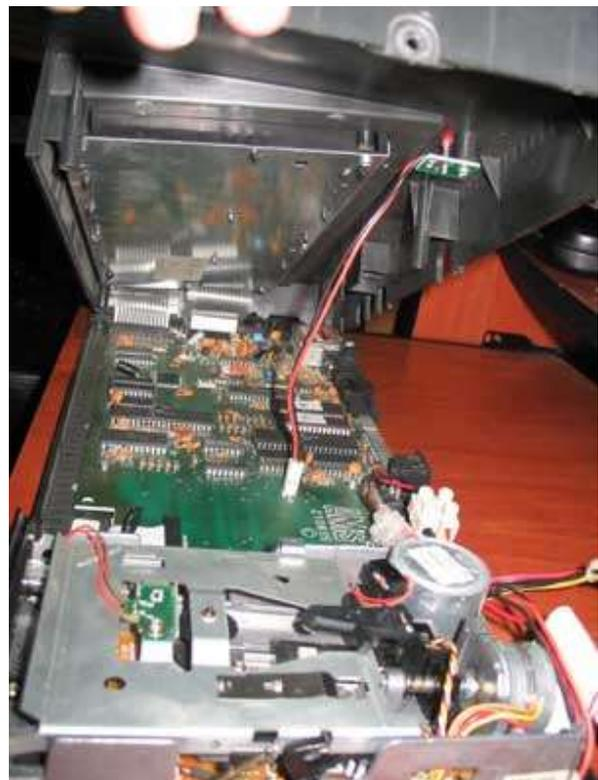
Imagen 2. Conexión del led indicador de encendido
