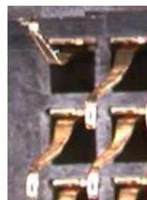
La imagen de la izquierda nos muestra un contacto del zócalo de la CPU doblado, revisarlo concienzudamente antes de insertar el Chip.
