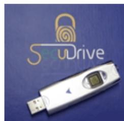
SecuDrive es el primer dispositivo USB que almacena las contraseñas de Internet mediante la identificación de la huella dactilar del propietario del aparato.
