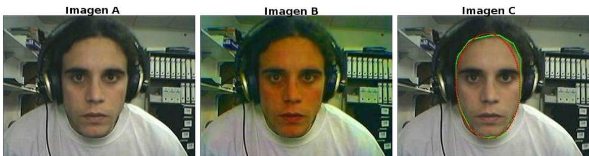
**A:** Imagen original. **B:** se ha aumentado la saturación logrando resaltar la piel visualmente (y hacer evidente el tinte anaranjado). **C:** detección del óvalo facial utilizando colorimetría (se ha obtenido un blob del que se ha calculado un contorno poligonal: en verde, y una elipse de ajuste: en rojo).
