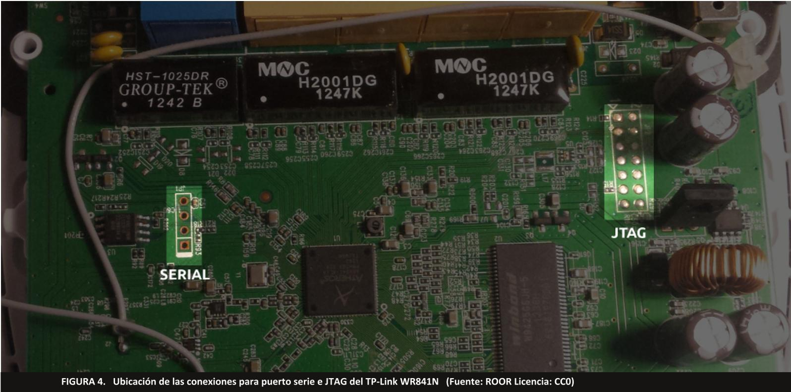
FIGURA 4. Ubicación de las conexiones para puerto serie e JTAG del TP-Link WR841N (Fuente: ROOR Licencia: CC0)
