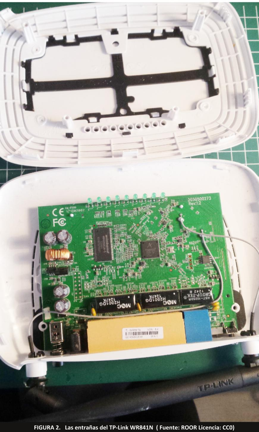
FIGURA 2. Las entrañas del TP-Link WR841N ( Fuente: ROOR Licencia: CC0)
