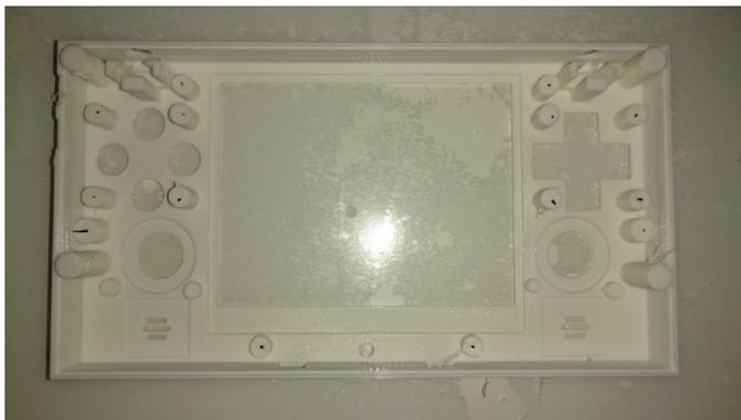
**Figuras 2 y 3 - Vista interna posterior de la carcasa. Se puede ver el espacio de las baterías en la parte inferior y algunas ranuras para la disipación térmica de la CPU + GPU.**
