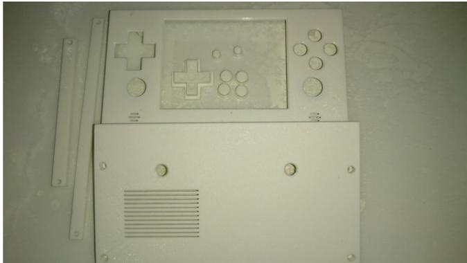
**Figura 1 - Vista interna del frontal de la carcasa. Los puntos negros son marcas para hacer agujeros para la inclinación**
