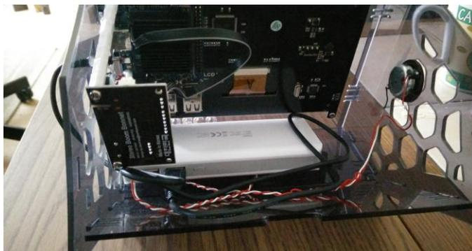
**Figura 13: Esta batería de 12500 mA debería proporcionarte entre 3-5 horas de entretenimiento móvil para jugar, ver películas o escuchar música**
