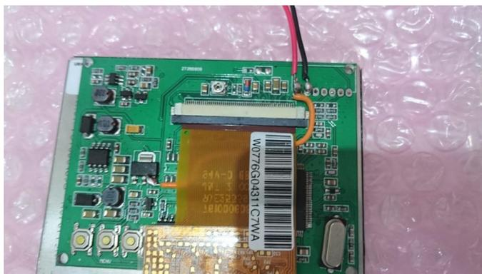
**Figura 6 - Primer plano del cableado 5V de ODROID**
