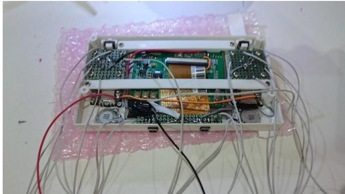
El siguiente paso a realizar en la parte frontal de la carcasa es añadir los altavoces, los botones de inicio/selección y cablear todo con una puesta a tierra común. Los pasos finales antes del cierre son añadir un disipador de calor, colocar los botones L2 + R2 y la placa base en la parte posterior de la carcasa, luego soldar todo a GPIO. Ten en cuenta también el cable amarillo que es la salida compuesta del ODROID que va a la entrada 1 de la pantalla.
