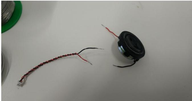
**Figura 7: No cortes los cables demasiado cerca de los altavoces, por si tienes que volver a empezar de nuevo. Enrosca los extremos del cable que están al descubierto.**
