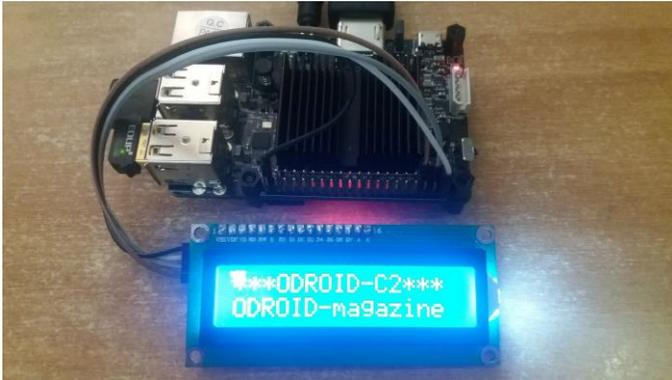
**Figura 4 - Pantalla LCD mostrando un mensaje de dos líneas**
