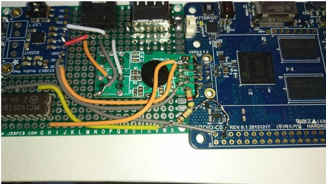
**Figuras 18 y 19 – Primer plano del cableado del multiplexor analógico**
