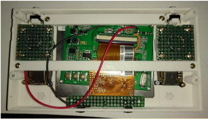
Figuras 23 y 24: Pasos del montaje final de los componentes dentro de la carcasa
