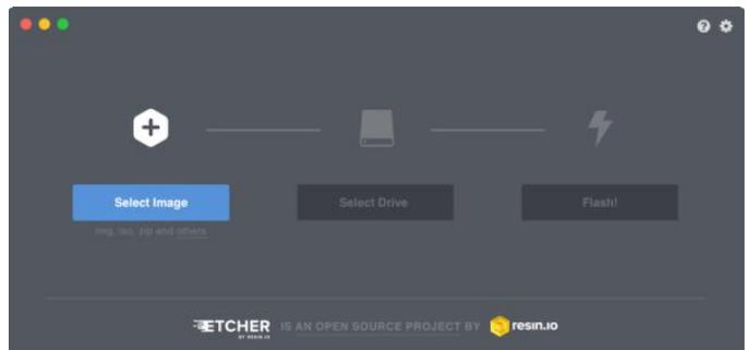
**Figura 5: Etcher te permite escribir imágenes pre-configuradas en una tarjeta microSD**
