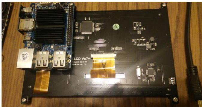
**Figura 2 - Fijando el ODROID-C1+ en la parte posterior del Vu7 Plus**
