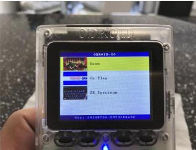
**Figura 1 – Coloca los archivos .fw en ODROID/firmware, luego apaga, presiona B, enciende y deja presionando B hasta que aparezca el menú**
