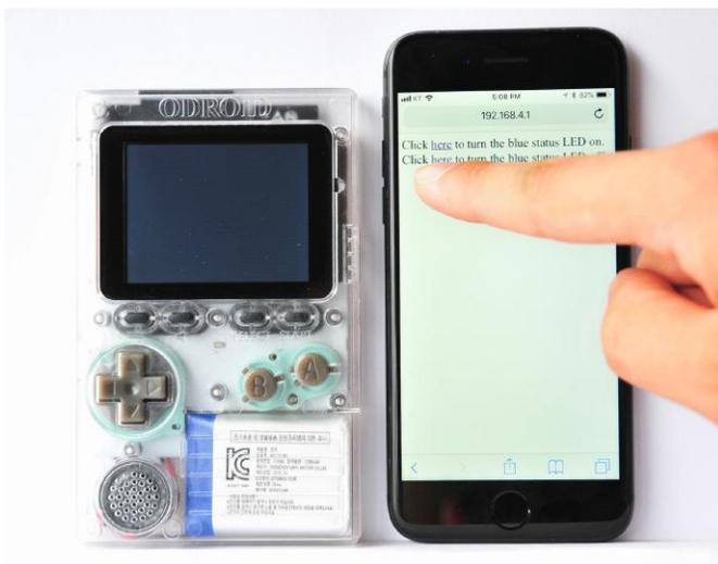
Figura 1 – Ejemplo de LED controlado por wifi
