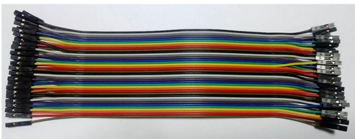
Ilustração 1 - Jumper-wires
