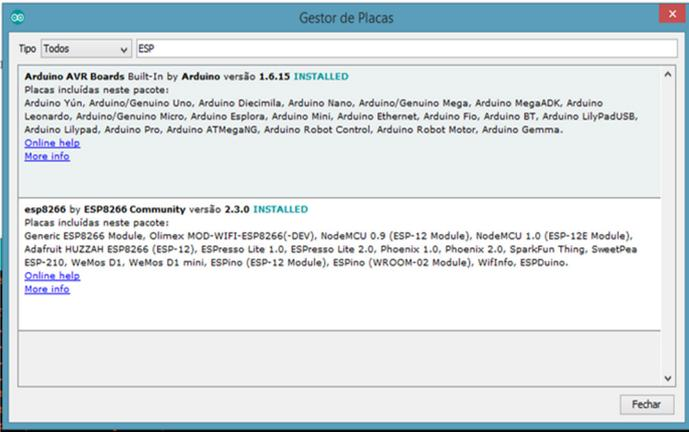
Ilustração 10 - Adicionar o módulo ESP8266 ao Arduino IDE
