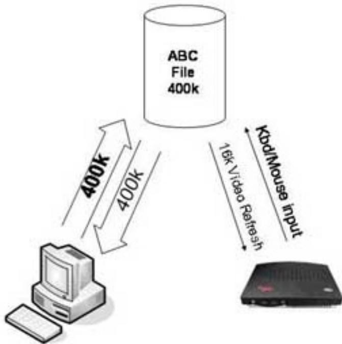
Figura 3: Arquitectura de funcionamiento de una Terminal ligera.
