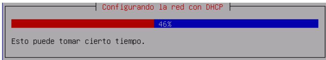
5. El paso anterior debe funcionar correctamente ya que el servidor LliureX del aula debe tener el servicio **DHCP** funcionando. Pero si la máquina cliente no pudiera acceder al servidor **DHCP** se
