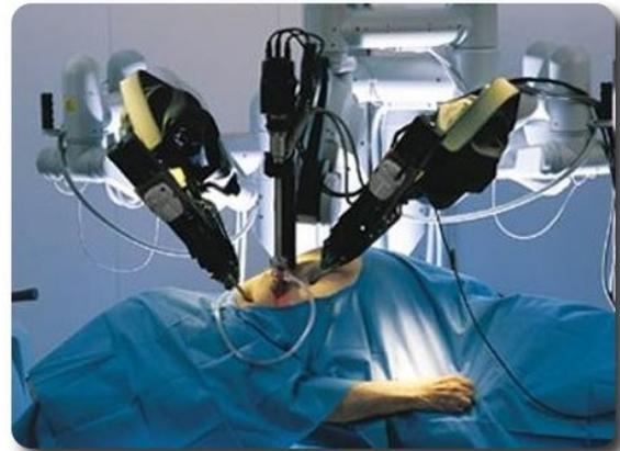
Se cuenta con cuatro brazos robóticos, un brazo-endoscopio, y tres instrumentos para el brazo. Los instrumentos están diseñados con siete grados de movimiento, para imitar la destreza de la muñeca y mano humana, cada instrumento tiene un fin determinado como de sutura de tejidos, pinzación y manipulación, cuya velocidad en los cambios de instrumento durante el proceso quirúrgico es bastante elevada.
