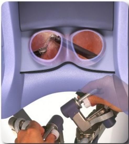
Da Vinci responde a los movimientos del cirujano (por supuesto el robot no opera solo, necesita un profesional) el cual esta muy cómodamente sentado manipulando los controles que están debajo de una pantalla, la cual gracias a los dos canales de alta definición puede mostrar una imagen en 3D en tiempo real, el sistema traduce a la perfección los movimientos del cirujano, filtrándolos y poniéndolos a una escala debida para el paciente.
