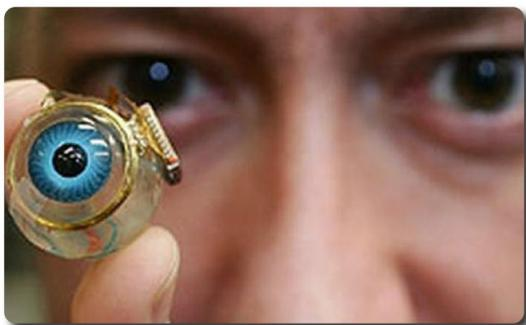
El dispositivo, bautizado como Argus 2, fue realizado por la empresa californiana Second Sight Medical Products y está compuesto por electrodos implantados en la retina y unas lentes equipadas con una cámara en miniatura.
