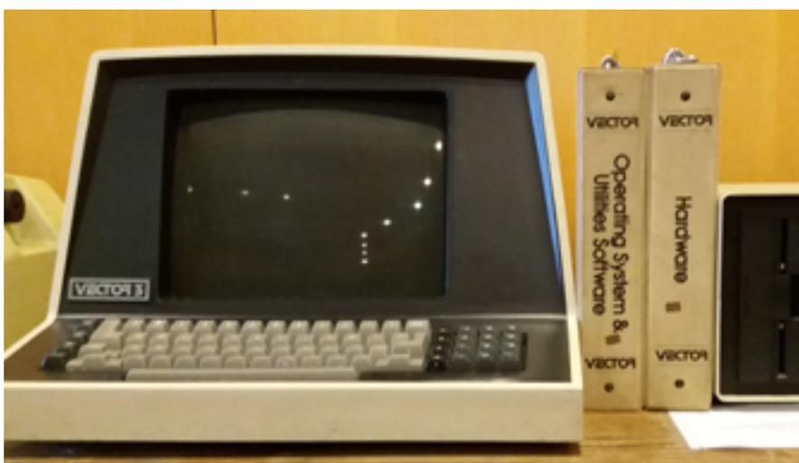
Figura 6. Microcomputador Vector3 como el utilizado en la Vicaría de la Solidaridad.
