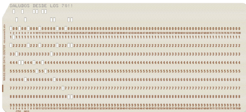
Figura 1. Tarjeta de 80 columnas para perforar programas y datos para el computador IBM/360.
