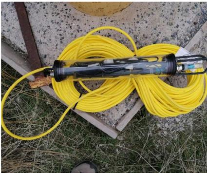
a. Versión final prototipo carcasa y cable de datos.
