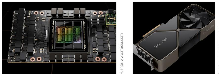
**Figura 3.** GPUs: NVIDIA H100 (izquierda) y GPU consumidor RTX 4090 (derecha).
