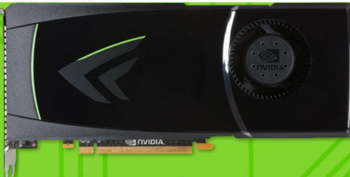
que necesita de un conector PCIE de 6 pines más otro de 8 pines: toma 75W del spot PCIE, más 75W del conector 6 pines, más 150W del conector 8 pines, totalizando 300W (siempre debe sobrar la alimentación, principalmente para cuando se aplica overclock a la placa, donde el consumo aumenta considerablemente).
