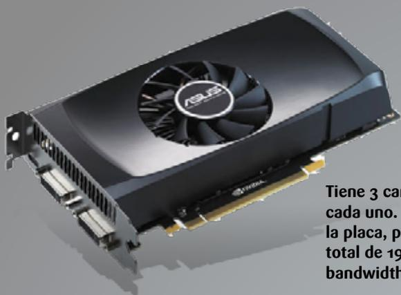
Tiene 3 canales de 64 bits y 256 MB cada uno. Esta cuenta da los 768MB de la placa, pero con un ancho de banda total de 192 bits - un 25% menos de bandwidth que la versión de 1GB.
