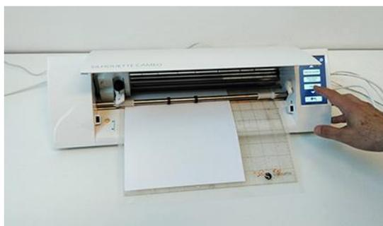
Figura 6: Plotter de corte de bajo coste de la marca Silhouette Studio
