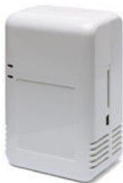
O SheevaPlug é um computador movido a Linux em um formato minúsculo (110 x 69.5 x 48.5 mm) que pode ser encaixado diretamente numa tomada elétrica. Este pequeno notável conta com ligações USB2.0 e Gigabit Ethernet. O processador é um
