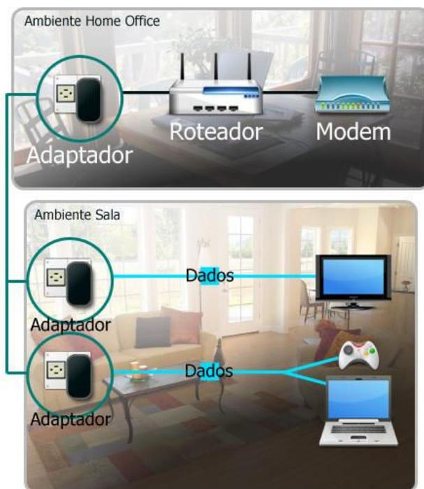
Figura 1: Exemplo de uma rede PLC
