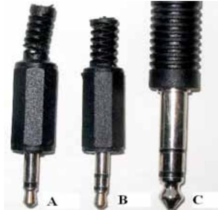
Los anillos negros, son aislantes que separan un canal de otro, o un canal de la referencia (GND), que es el más alejado de la punta del conector.
