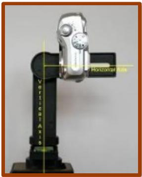
Girar em torno do *No Parallax Point* (NPP – ponto sem diferença de perspectiva) facilita, e muito, a montagem posterior.
