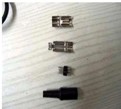
Figura 2. Clavija DIM 8 macho
