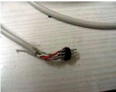
Figura 6. Soldando el conector DIN 8
