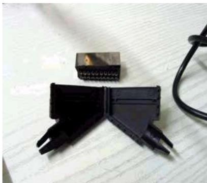
Figura 1. Clavija SCART macho
