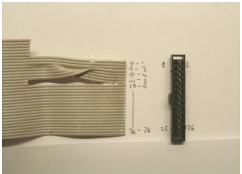
Presentamos el cable sobre el conector IDC 26 el cual solo puede ser puesto en una posición. En el conector hay una flecha en un extremo que indica cual es el cable número 1. Si no encontramos la flecha nos podemos valer de la muesca grande en el centro del conector. En la foto se puede ver que el cable número 1 es el primer cable empezando por arriba y que no se ve la muesca (está en la otra cara)
