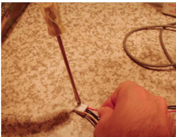
Cómo intercambiar los cables rojo y amarillo con ayuda de un destornillador
