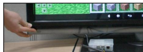
Preparando la pantalla: Fijando la cinta de doble cara al marco de la pantalla táctil
