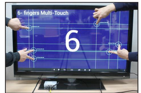
Prueba de la pantalla táctil - 6 puntos garantiza la integración de sensor con el software.
