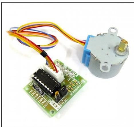
Figura 3a - Motor de paso 28BYJ-48 de 5V con la placa controladora ULN2003
