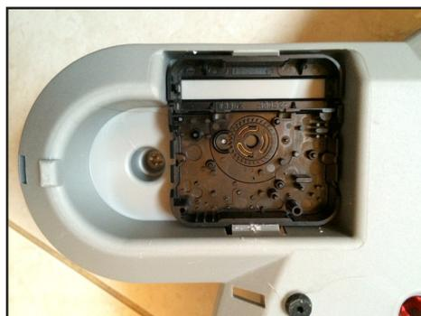
Figura 2a - Mecanismo de reloj sin el engranaje de la palanca visible
