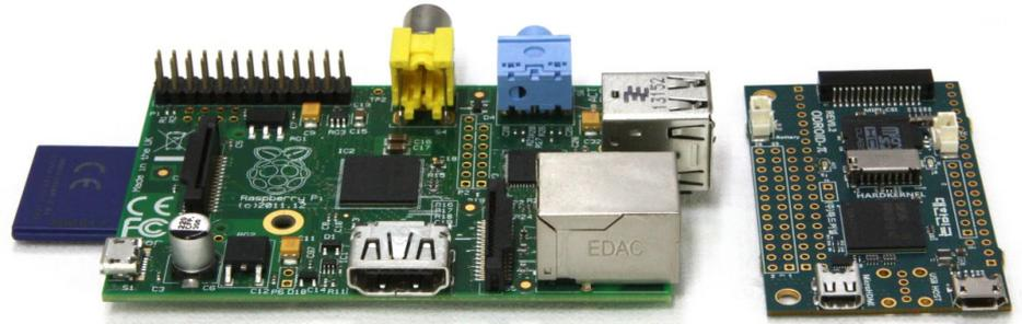
**Comparando la diferencia de tamaño entre el Rpi y el ODROID-W**
