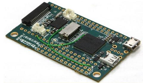
**Vista de la parte superior de la rev. 1 de la placa ODROID-W**
