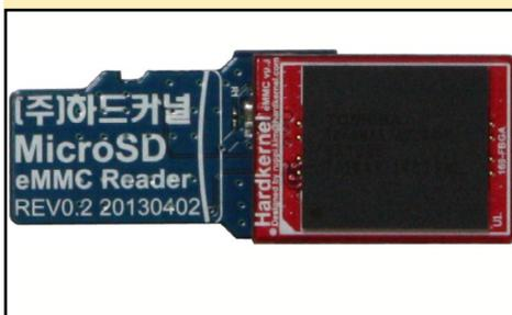
Vista superior placa lectora eMMC y el módulo eMMC insertado en el lector SD
