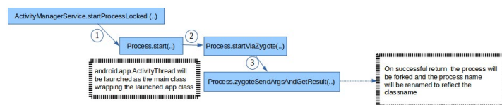
Figura 4 : Flujo de lanzamiento de una App
