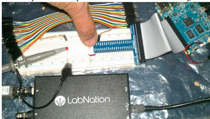
Figura 7: Instalación osciloscopio Smartscope
