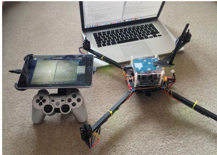
Los componentes del QuadCopter son una tablet y un mando PS3
