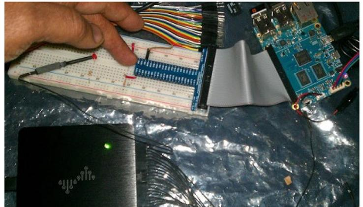
**Figura 5: Configuración del analizador lógico DSLogic**
