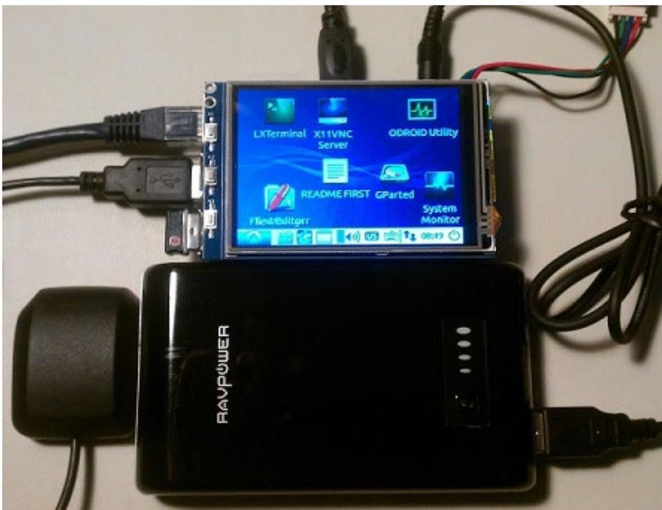
Figura 1: Montaje del ODRROID-C1, el GPS, la pantalla táctil y la batería
