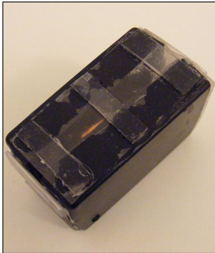
Termina el exterior con láminas de vinilo, plástico grueso u otro material que sea poco visible. ¡Ahora dispones de un pequeño ordenador Linux del tamaño de un enchufe!
