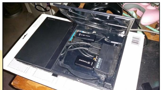
**De arriba a abajo, todos los pasos para crear la carcasa PS2 personalizada: montar el hub USB en el interior, conectar todos los componentes, sellarlos en la parte trasera y organizarlos para facilitar su sustitución**
