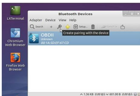
Figura 10 - Conexión del C1 y el adaptador OBDII usando Bluetooth
