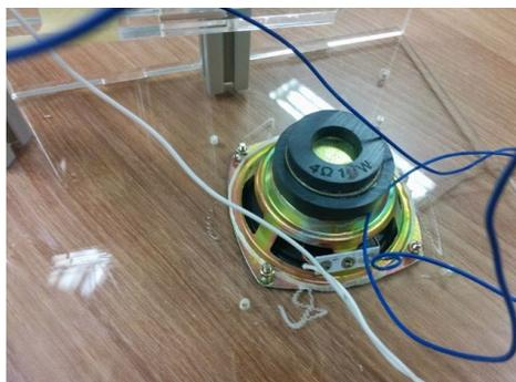
**Figura 7 - Altavoz interno montado en el frontal de la tapa**
