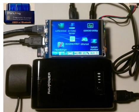
Figura 1: C1, GPS, OBDII, pantalla táctil y batería montados
