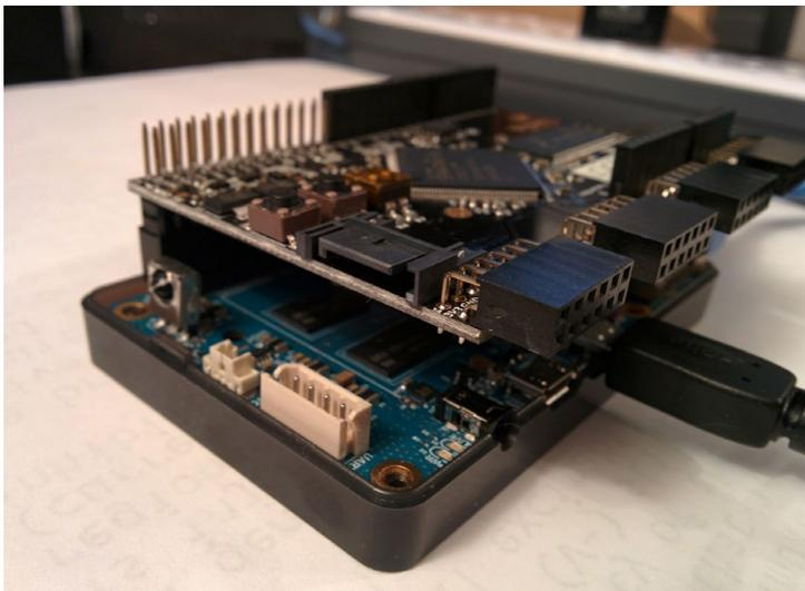
**Placa LogiPi FPGA conectada aun ODROID-C1, usada pra aprender a programar con FPGA**
