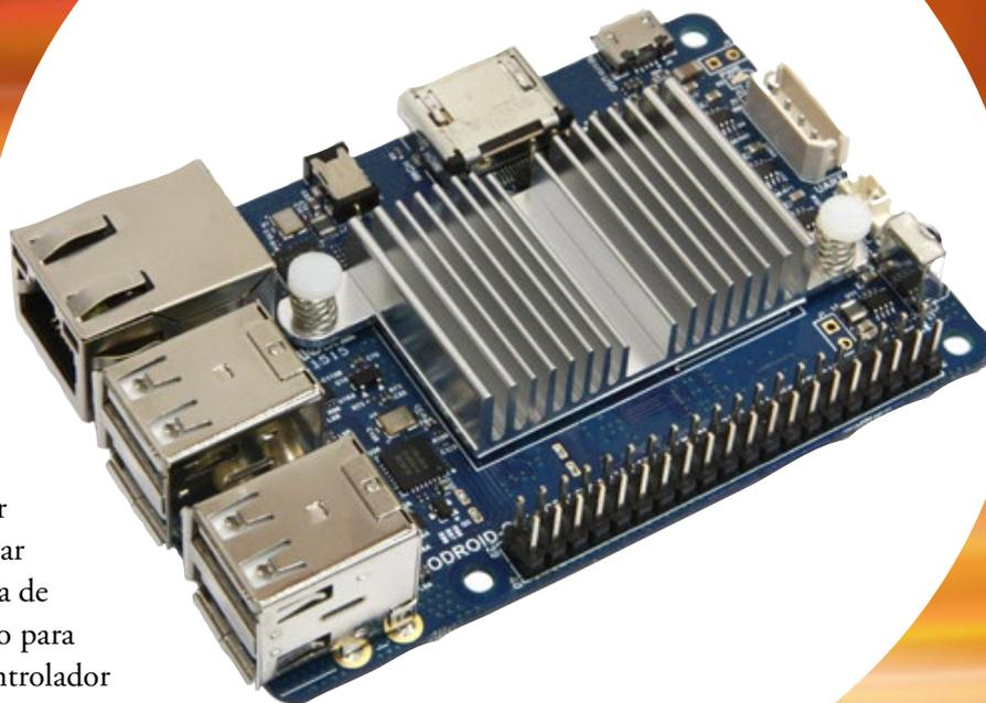
Una característica muy interesante del ODROID-C1 es la presencia de una hilera de pines GPIO (Entrada/Salida de Propósito General) situados a lo largo del borde del dispositivo. Estos pines son la interfaz física entre la placa y el mundo exterior. El cabezal de 40 pines incluye SPI, I2C, UART, ADC y función GPIO.
