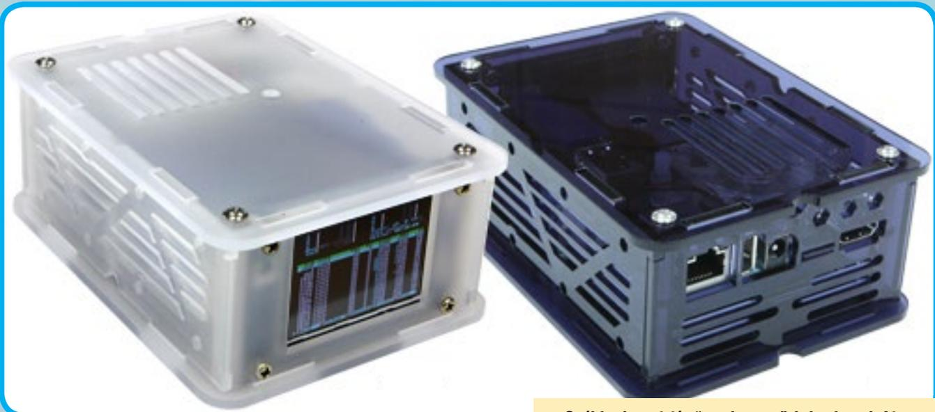
**E**l Cloudshell para ODROID-XU4 es una económica solución de Almacenamiento en Red (NAS) para crear tu propia nube personal. Incluye una pantalla de consola LCD a color en el frontal, un conector SATA a USB 3.0 (Génesis GL3321G) y suficiente espacio en el interior como para montar un disco duro de 2,5 pulgadas y una placa XU4. Es una estupenda forma de tener un XU4 con gran capacidad de almacenamiento dentro de una carcasa compacta y portátil.
