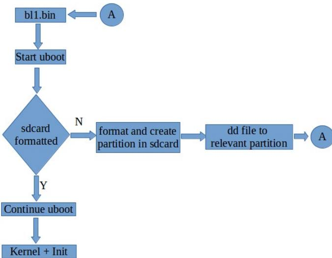
**Figure 3: Boot flow ODRROID-CI**
