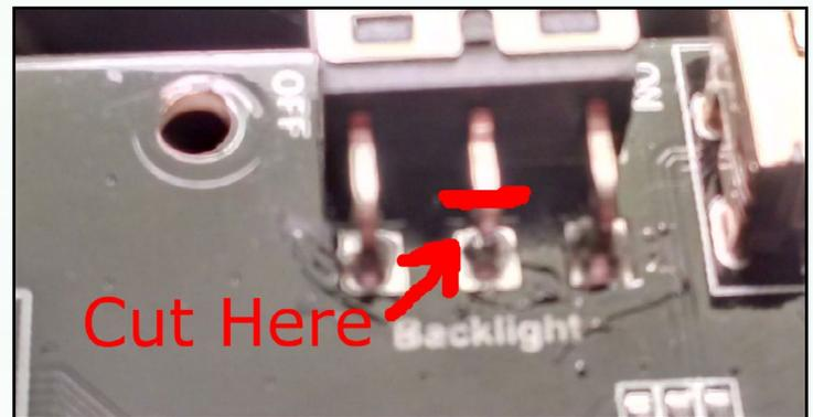
Figura 2 - Pin central del interruptor físico del hardware que debe cortarse,
