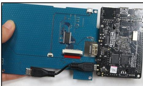
Figura 13 - Conecta el cable USB micro a micro, que proporciona al C2 o CI+ la energía a través de la placa convertidor
