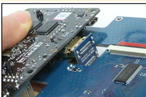
Figura 9 - Empuja firmemente para que la conexión HDMI sea estable
