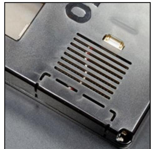
Figura 4 - Rejillas de ventilación y línea de corte para el puerto GPIO de 40 pines
