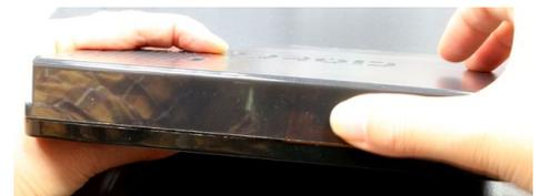
Figura 28 - Presiona los lados de la caja posterior a la vez y razonablemente fuerte para enganchar las piezas de bloqueo
