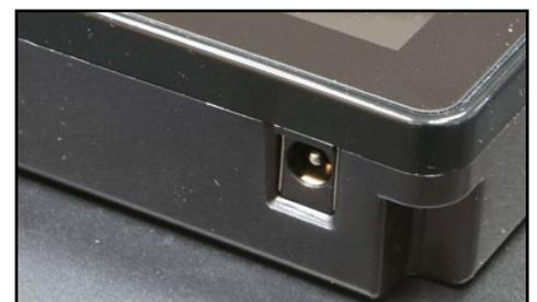
Figura 5 - Entrada PSU 5V/4A
