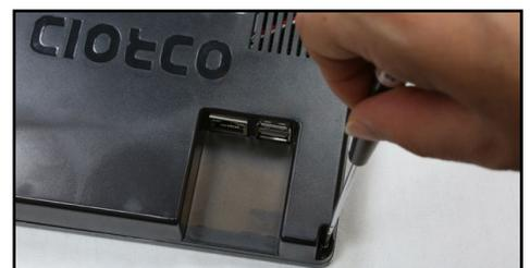
Figura 29 - Inserta y aprieta los tornillos en los cuatros agujeros de las esquinas en los laterales
