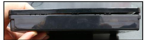
Figura 27 - Cierra la carcasa. Asegúrate de no dañar el sistema y los frágiles FPCBs que hay dentro de la carcasa
