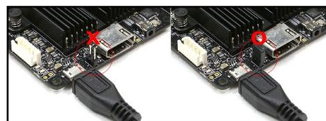
Figura 14 - Los dos pines puente deben estar conectados para dar entrada a la energía a través del conector microUSB
