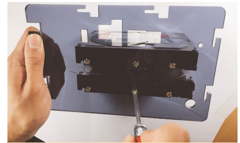
Figura 6 - Atornilla las piezas izquierda y derecha a los discos duros (A + B + P)
