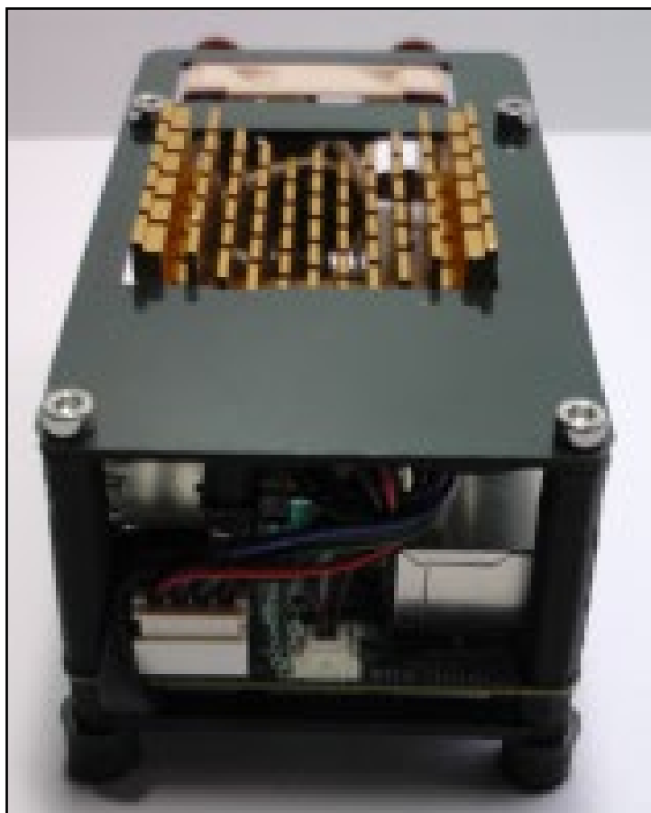
Vista superior donde se observa la apertura del disipador de calor
