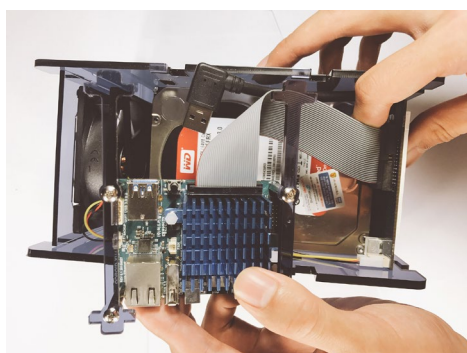
Figura 12 - Conecta el cable plano GPIO y el cable USB 3.0 entre el ODR0ID-XU4 y la placa CloudShell-2 (F + H)
