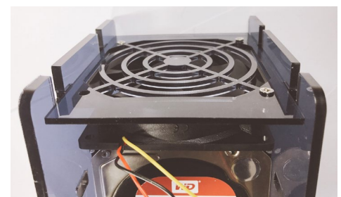
Figura 9 - Monta el ventilador y la pieza trasera y coloca el ventilador en la parte posterior, asegurándote de usar sólo 3 tornillos en este paso (E + G + N)
