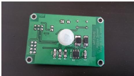
Figura 2a - PCB del sensor de movimiento nRF24 - Vista superior
