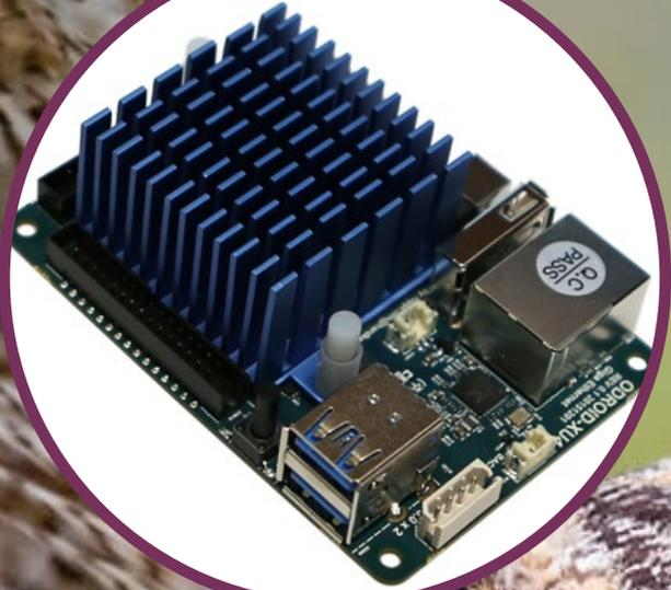
**El ODROID-XU4Q viene con un disipador de calor pre-instalado en lugar de un ventilador**
