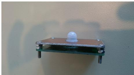
Figura 2b - PCB del sensor de movimiento nRF24 - Vista lateral
