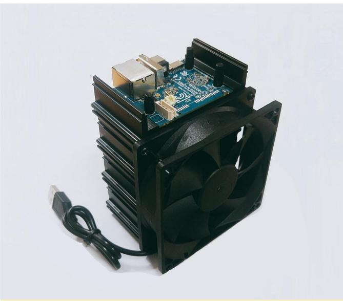
La refrigeración de 4 ODROIDS con un único ventilador supone una gran reducción de los costes
