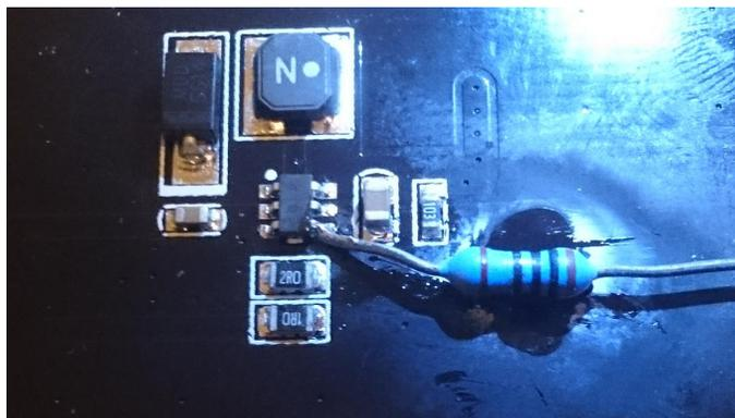
Figura 2 - Primer plano de la conexión soldada
