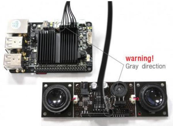
Figura 5 - Conectando el Stereo Boom Bonnet a un ODROID-C1+/C2to an ODROID-C1+/C2
