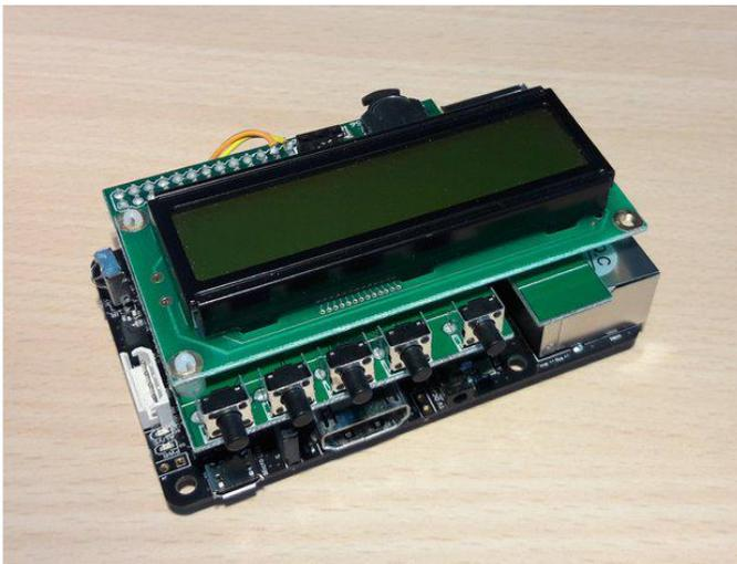
Figura 2 - Otra perspectiva del ODROID-C2 y PiFace montados
