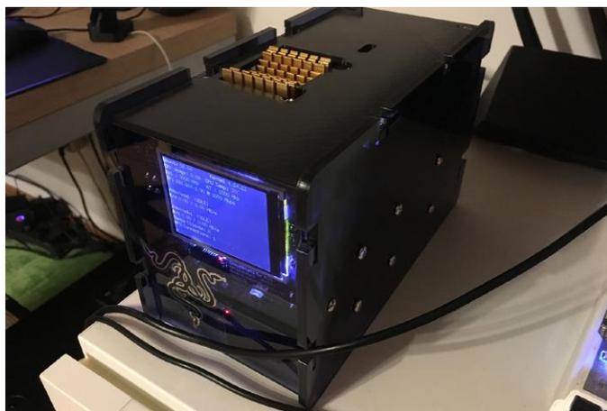
**Cristian imprimió en 3D una tapa personalizada para su ODROID-XU4 que presenta un hueco para el disipador de calor**
