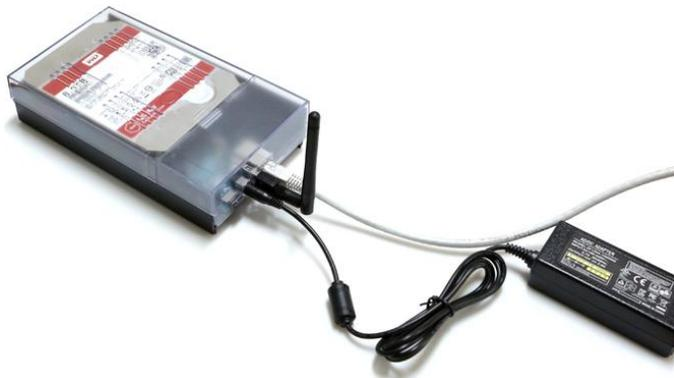
**Figura 2: Típica configuración de un ODROID-HC2 con una tarjeta microSD de 8GB, disco duro de 3.5 pulgadas, fuente de alimentación de 12V/2A, cable Ethernet y carcasa ODROID-HC2**
