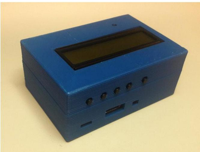
Figura 4: una carcasa personalizada impresa en 3D para la PiFace
