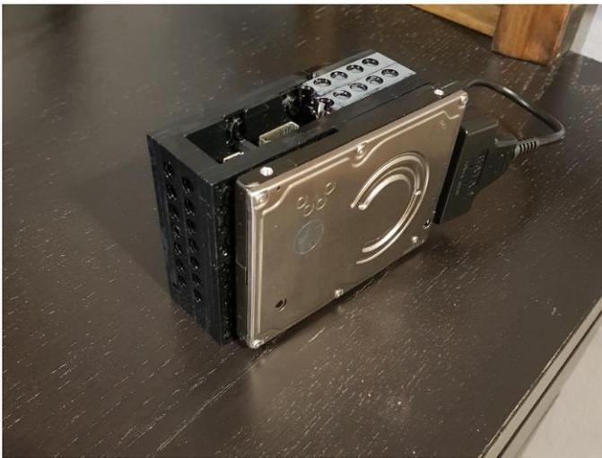
**Figura 4 - Unidad de disco duro conectada**
