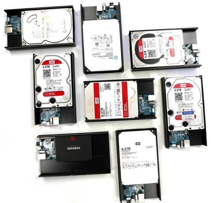
**Figura 7 - El ODROID-HC2 ha sido probado con diversas unidades de 3,5 pulgadas, así como con varios sistemas de almacenamiento de 2,5 pulgadas**
