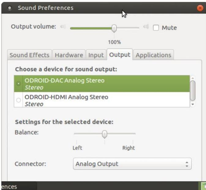
Figura 13 – Seleccionando la salida: ODROID-DAC Analog Stereo
