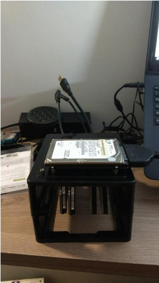
Figura 18 - Disco duro con los archivos del SO/Temp en la parte superior para facilitar el acceso
