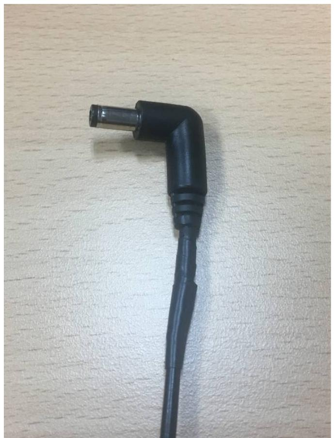
**Figura 6 - Para conectar el adaptador de alimentación a SmartPower2, cambiamos el conector por un cable tipo L de 5,5 mm**
