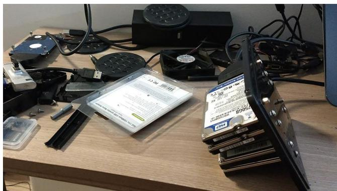
**Figura 17 - Taladrando los agujeros, fijando los espaciadores y las unidades de disco duro a la "carcasa"**
