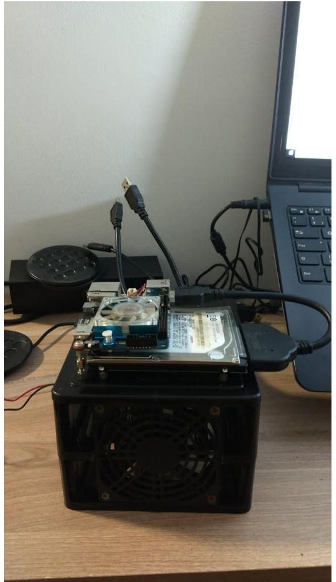
Figura 19 - No olvidemos la estrella del show. Coloqué el ODROID-XU4 (y un ventilador también)
