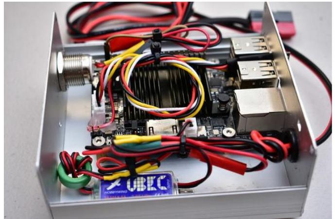
Figura 15 - Todo montado y todos los cables atados correctamente
