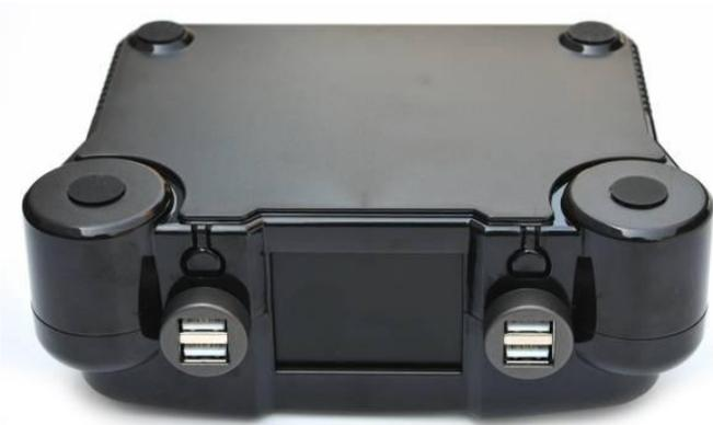
**Figura 8: Monta la carcasa inferior (B) y coloca la cubierta USB (F). A continuación, coloca las bases de goma (G) en la carcasa inferior**
