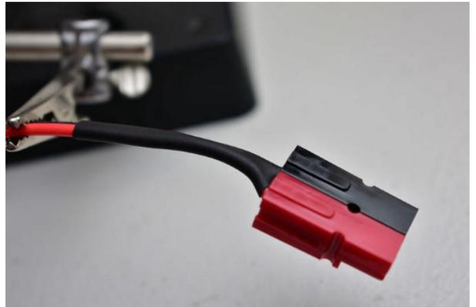
Figura 9: Añadí un poco de tubo termo retráctil para que trabajase a modo de presión con el cable
