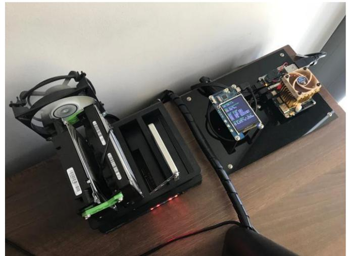
**Figura 10 - La vista final del servidor con los cables y láminas de acrílico montadas**
