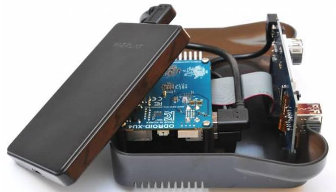
Figura 5 - Conecta la placa XU4 y la placa LCD con el cable USB2.0 (D)
