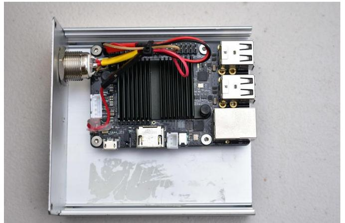
Figura 10 - El ODR0ID montado usando separadores de latón. El residuo procede de una cinta de doble cara de un intento anterior
