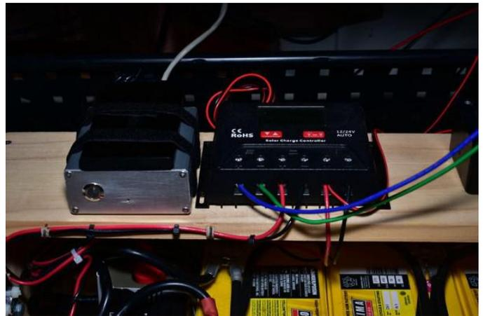
Figura 20 - Aquí tienes el microservidor colocado al lado del controlador de carga del sistema solar y conectado a la caja de distribución de energía Anderson
