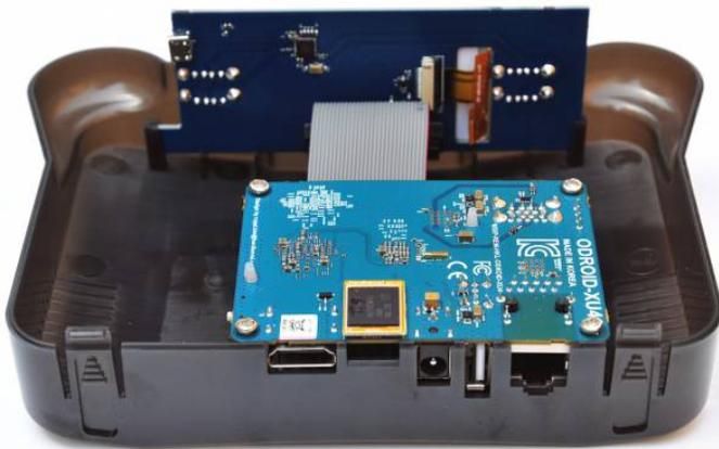
Figura 3 - Monta la placa LCD + el XU4 en la carcasa superior (A) y fija los tornillos (H)
