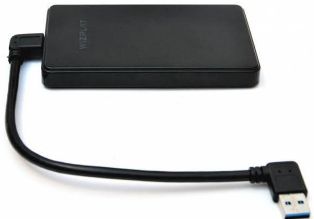
Figura 7 - Puedes conectar un HDD de 2.5" usando el cable USB3.0 (I) incluido en el pack y asegurar la unidad de disco duro a la carcasa inferior con cinta velcro. El pack no incluye una unidad de disco duro. Si tu almacenamiento HDD consume más de 500 mA, es posible que necesites utilizar una fuente de alimentación de 5V/6A en lugar de una de 5V/4A
