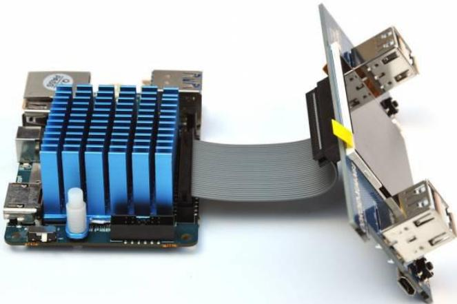
Figura 2 - Utiliza un cable plano de 30 pines (E) para conectar el XU4 y la placa LCD (C). A continuación, retira la película protectora de la superficie de la LCD. El ODROID-XU4 se vende por separado
