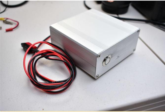
Figura 17 - Aquí tiene la carcasa completamente montada. Los agujeros para el USB, el conector de red y el botón de encendido fueron hechos a mano y hubo algunos rasguños. Esto puede evitarse usando cinta de pintores o usando mejores herramientas como un CNC o un taladro de banco
