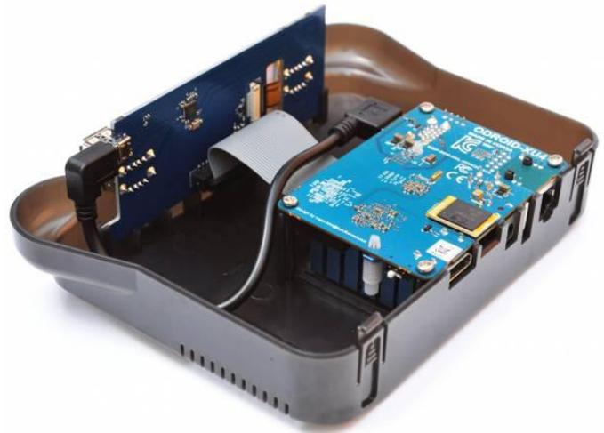
Figura 5 - Conecta la placa XU4 y la placa LCD con el cable USB2.0 (D)
