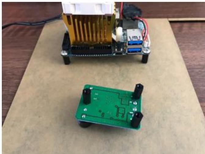
Figura 4 - Los separadores para el XU4 y el convertidor DC-DC
