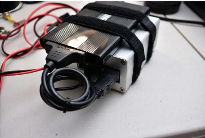
Figura 18 - El ODROID-C2 es compatible con almacenamiento eMMC y éste tiene una tarjeta de 16 GB que se utiliza para los archivos del sistema. Para el almacenamiento, se usa un disco duro SSD SATA externo con un adaptador SATA a USB
