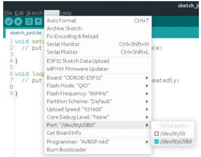
Figura 3 – Seleccionando un puerto serie adecuado en Linux
