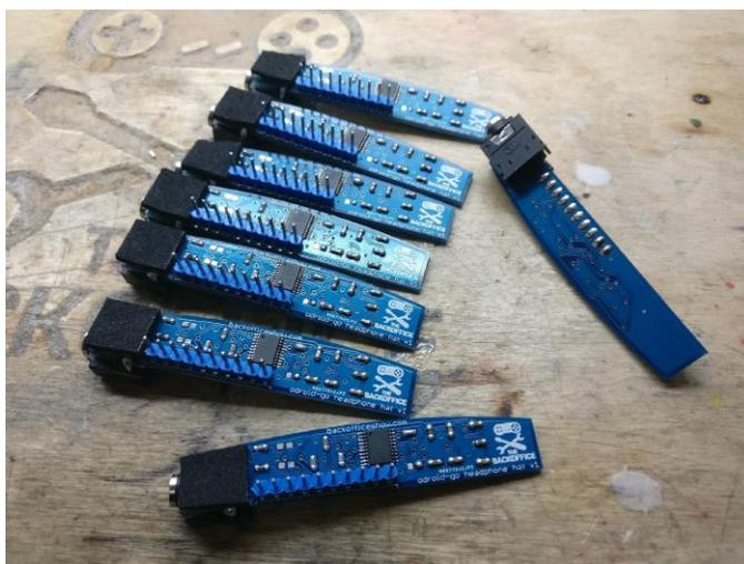
**Figura 8 – Odroid Audio Hard montados – Detalle de las placas v1 ensambladas a mano**
