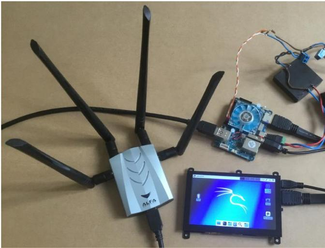
Figura 1 – Kali Linux 2018.2 en ODROID-XU4 con el adaptador Wifi Alfa conectado
