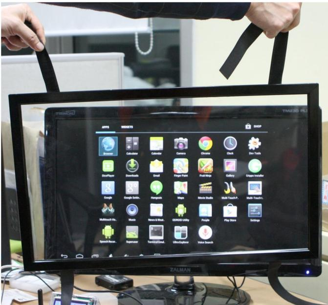
Figura 14 - Panel táctil de 23 pulgadas con correas de velcro
