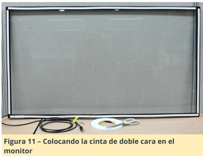
Figura 11 - Colocando la cinta de doble cara en el monitor
