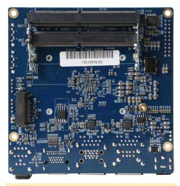
Figure 4 - Closeup of ODROID-H2 PCB
