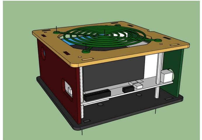
Figura 14 - Prototipo de diseño de la carcasa del ODROID-H2.
