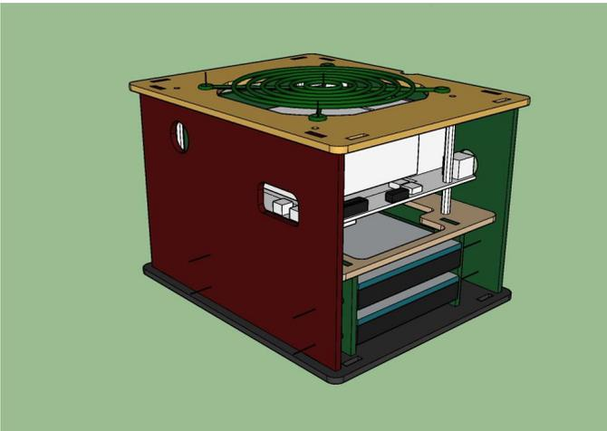
Figura 18 - Prototipo de diseño de la carcasa del ODROID-H2
