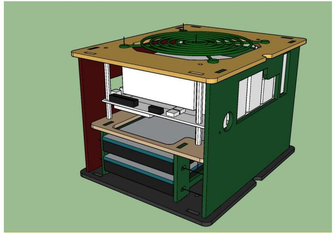
Figura 19 - Prototipo de diseño de la carcasa del ODROID-H2
