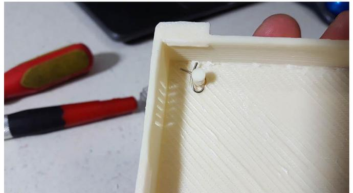
Figura 12: Tuvimos que hacer un pequeño orificio en el botón de encendido para poder sujetarlo con un clip.
