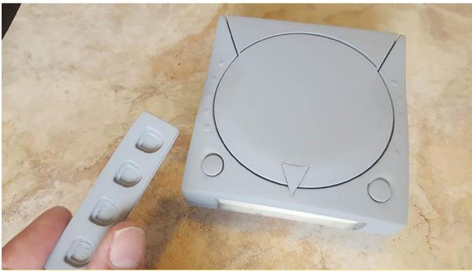
Figura 14: Tuvimos que hacer un pequeño orificio en el botón de encendido para poder sujetarlo con un clip.
