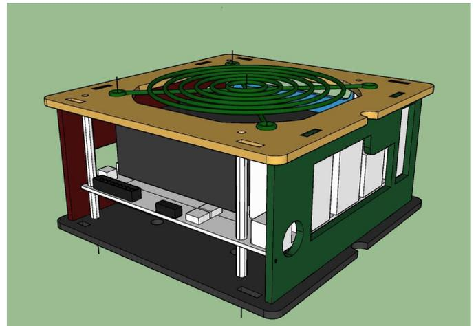
Figura 15 - Prototipo de diseño de la carcasa del ODROID-H2.
