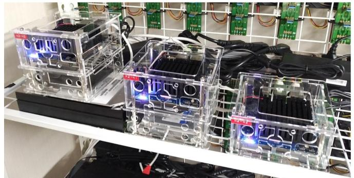
**Figura 5 - Tres configuraciones de ODROID-H2 con diferentes memorias DDR4**
