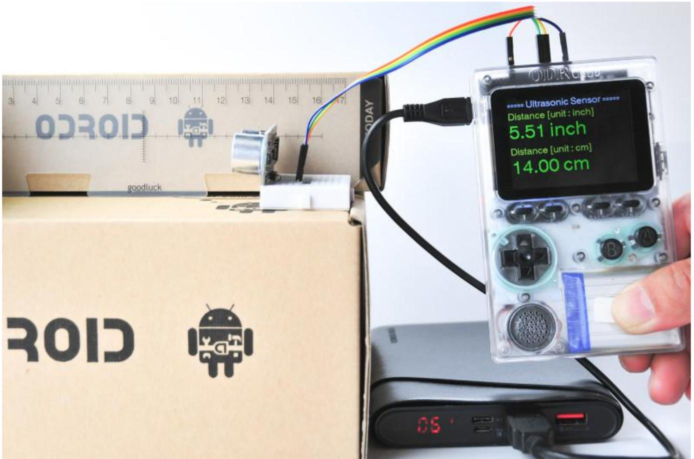
Vamos a aprender a usar la salida GPIO, la entrada IRQ y el reloj del sistema con un módulo de medición de distancias por ultrasonidos. Ten en cuenta que el sensor de distancia es un elemento adicional que es imprescindible.
