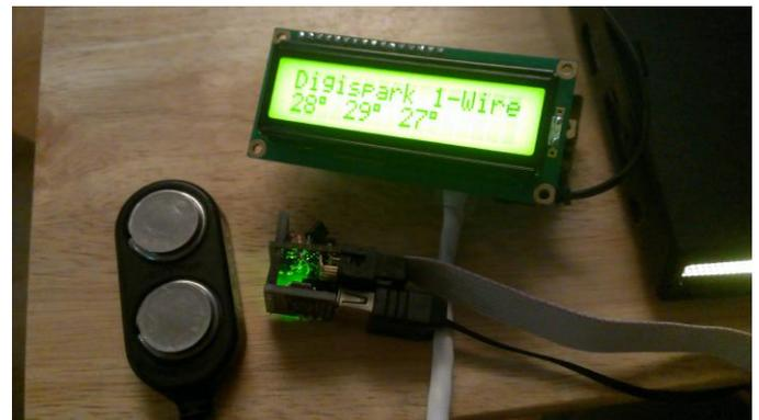
**Figura 6 - Proyecto prematuro de un sensor de temperatura 1-wire**
