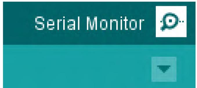
Figura 1 - El Serial Monitor de Arduino se activa con este botón.
