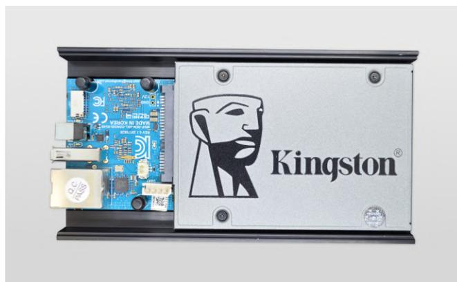
**Figura 1 - Mi servidor de semillas BitTorrent ODROID-HC1 con un SSD Kingston de 960 GB**
